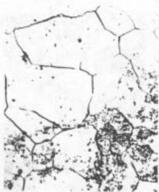
a. 70 % cold-rolled 2Al-2Ti alloy, 1000° C x 2hr.
